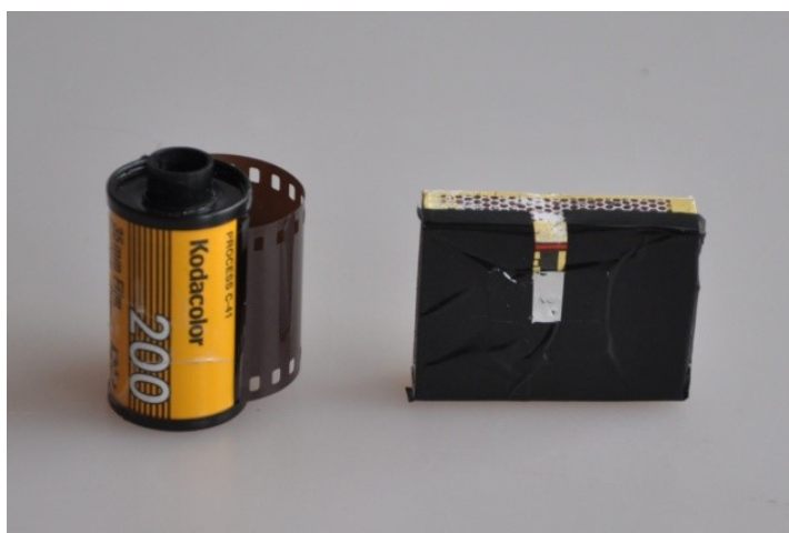
Obr. 27 - komora s přilepenou dírkou a kinofilm
