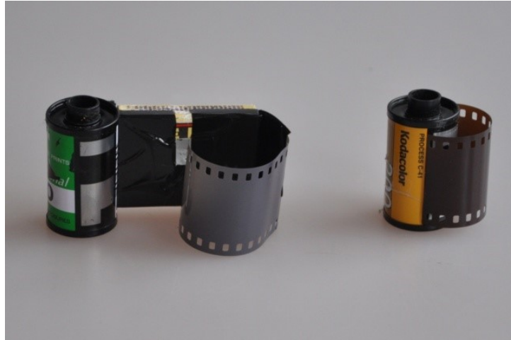
Obr. 28 - komora s dírkou a provlečeným filmem
