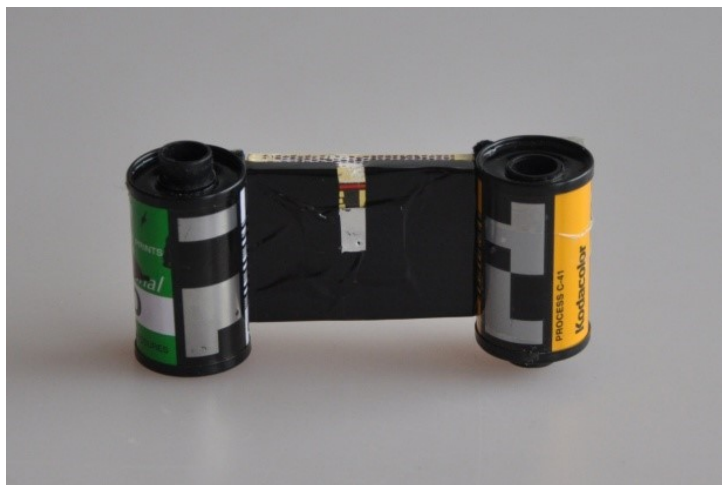
Obr. 29 - filmy jsou přilepeny k sobě a svinuty tak, aby přiléhaly ke komoře
