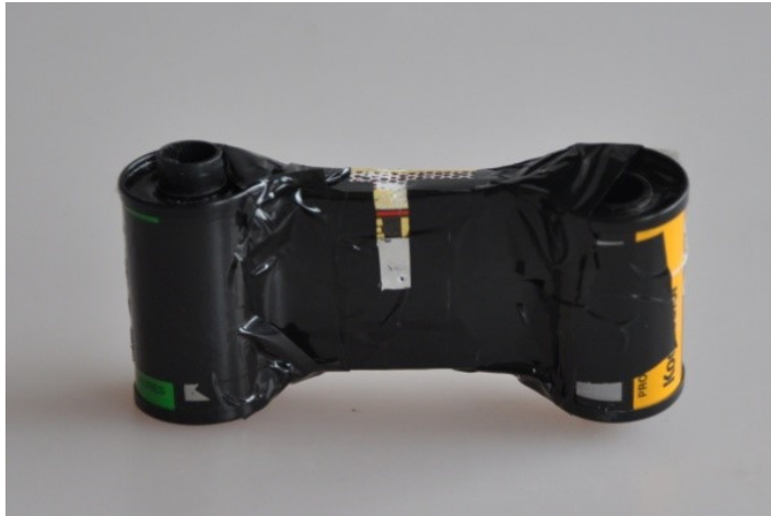
Obr. 30 - zalepená komora, černá lepicí páska brání světlu pronikat dovnitř
