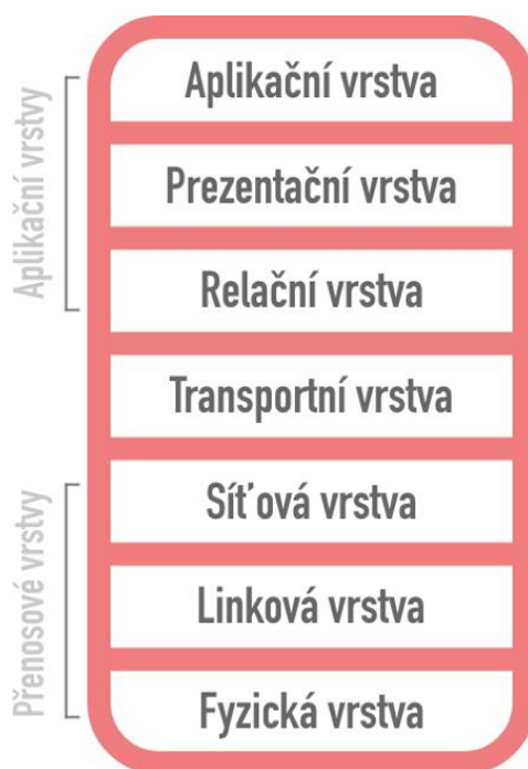
Obr. 4: Schéma referenčního modelu ISO/OSI (vlastní zpracování dle 7)
