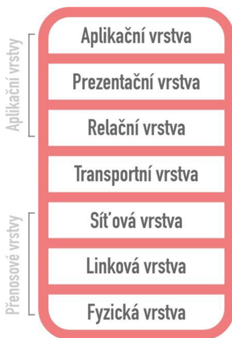
Obr. 4: Schéma referenčního modelu ISO/OSI (vlastní zpracování dle 7)
