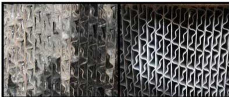
Obrázek 21: Zanášení u regenerátorů [15]
