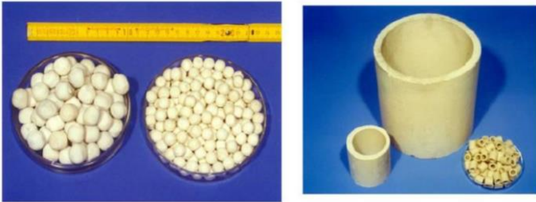
Obrázek 7: Výplň lože - keramické kuličky a Raschigovy kroužky
