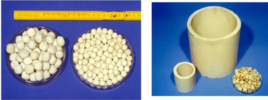
Obrázek 7: Výplň lože - keramické kuličky a Raschigovy kroužky
