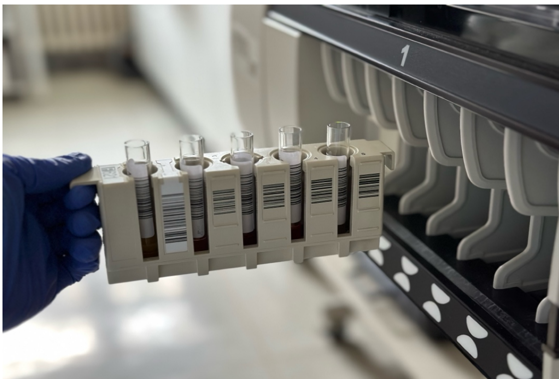
Obrázek 10 Stojan se vzorky – vložení vzorků do analyzátoru Architect i2000 SR (Zdroj: Vlastní)
