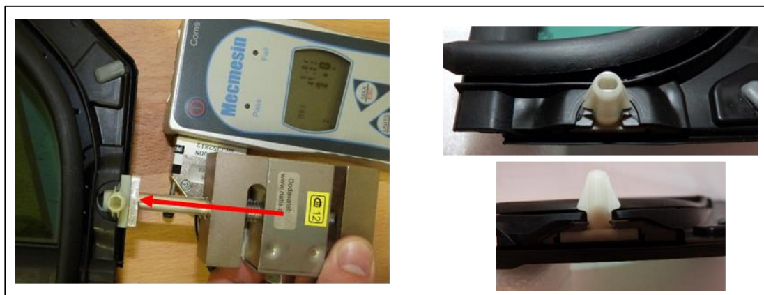
Obr. 3.15: Princip ručního měření montážní síly výměnného klipu do protikusu
