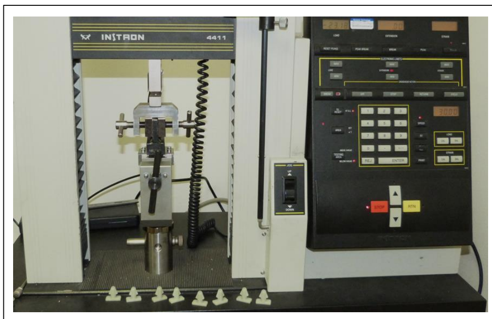
Obr. 3.12: Trhací stroj Instron 4411
