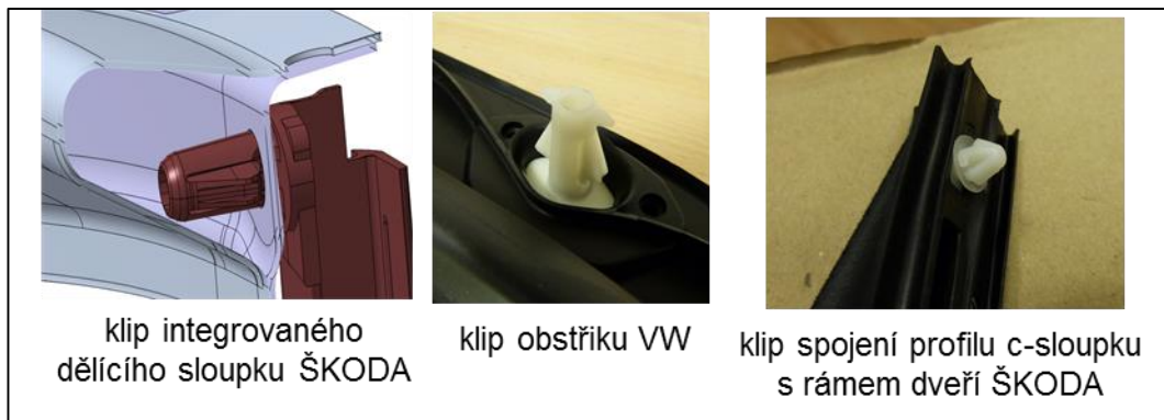
Obr. 2.14: Příklad aplikace klipů na dílech těsnění skel osobních automobilů
