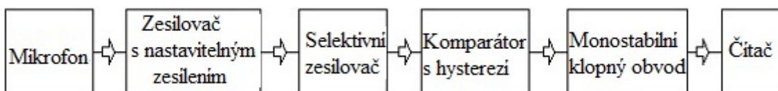
Obrázek 3-2 Blokové schéma detektoru Korotkových zvuků [2]
