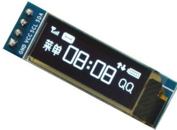
Obrázek 3-23 OLED I2C Displej 128x32 0,91" [25]
