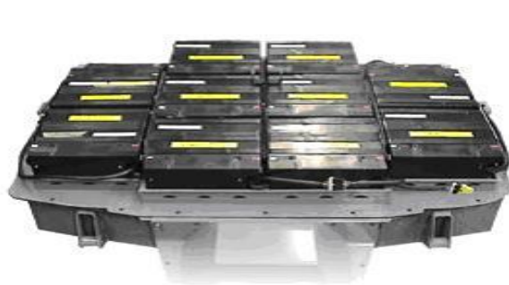
Obr. 25 Lithium-iontové články vyvinuté pro Mitsubishi firmou Matsushita Electric (Panasonic) [14]
