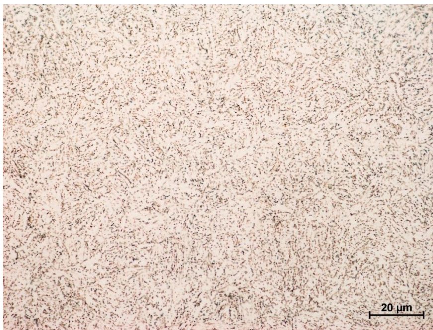
Obr. 19 Mikrostruktura vzorku č. 5 oceli 12 050, zvětšení 1000x
