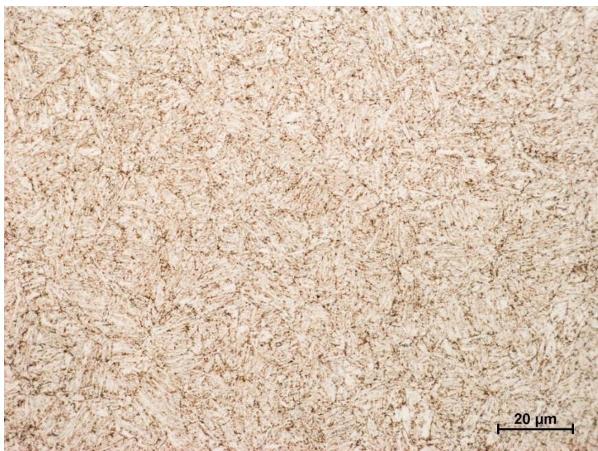
Obr. 17 Mikrostruktura vzorku č. 3 oceli 12 050, zvětšení 1000x
