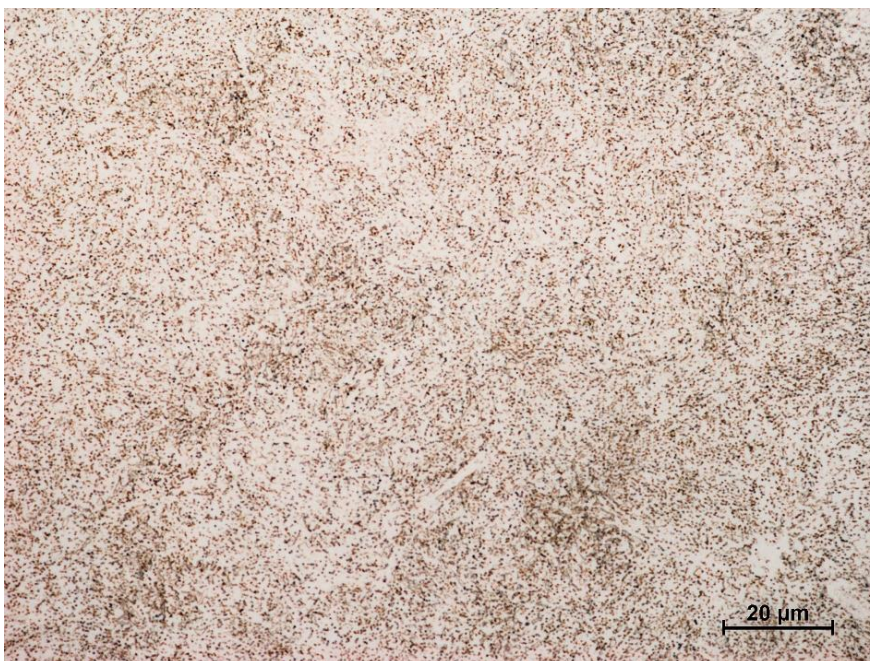
Obr. 47 Mikrostruktura vzorku č. 6 oceli 16 640, zvětšení 1000x
