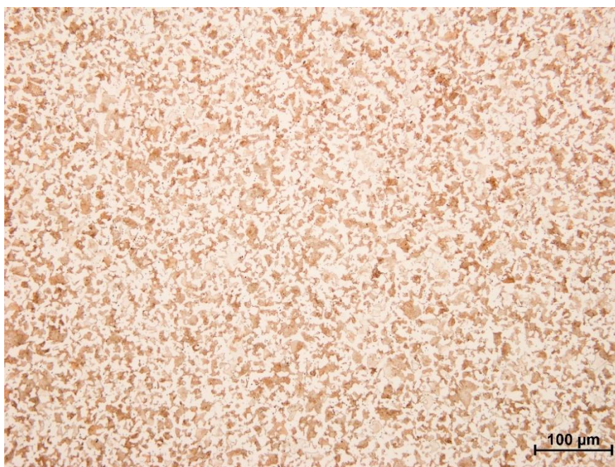
Obr. 14 Mikrostruktura vzorku č. 1 oceli 12 050, zvětšení 200x
