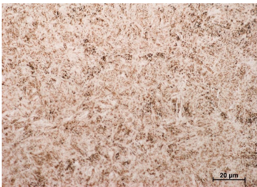
Obr. 37 Mikrostruktura vzorku č. 2 oceli 15 241, zvětšení 1000x
