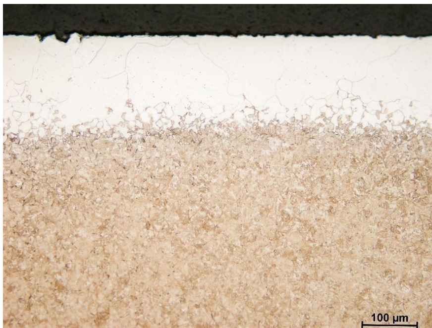
Obr. 26 Oduhličený okraj vzorku č. 9 oceli 12 050, zvětšení 200x
