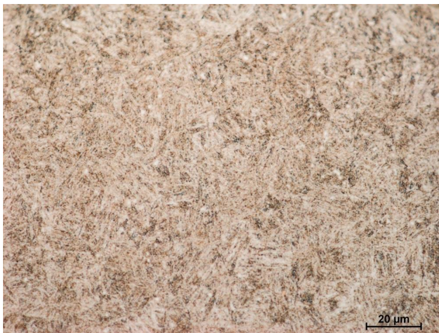
Obr. 30 Mikrostruktura vzorku č. 2 oceli 14 331, zvětšení 1000x
