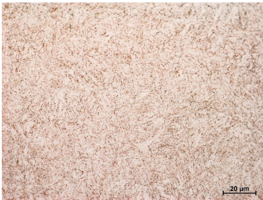
Obr. 18 Mikrostruktura vzorku č. 4 oceli 12 050, zvětšení 1000x
