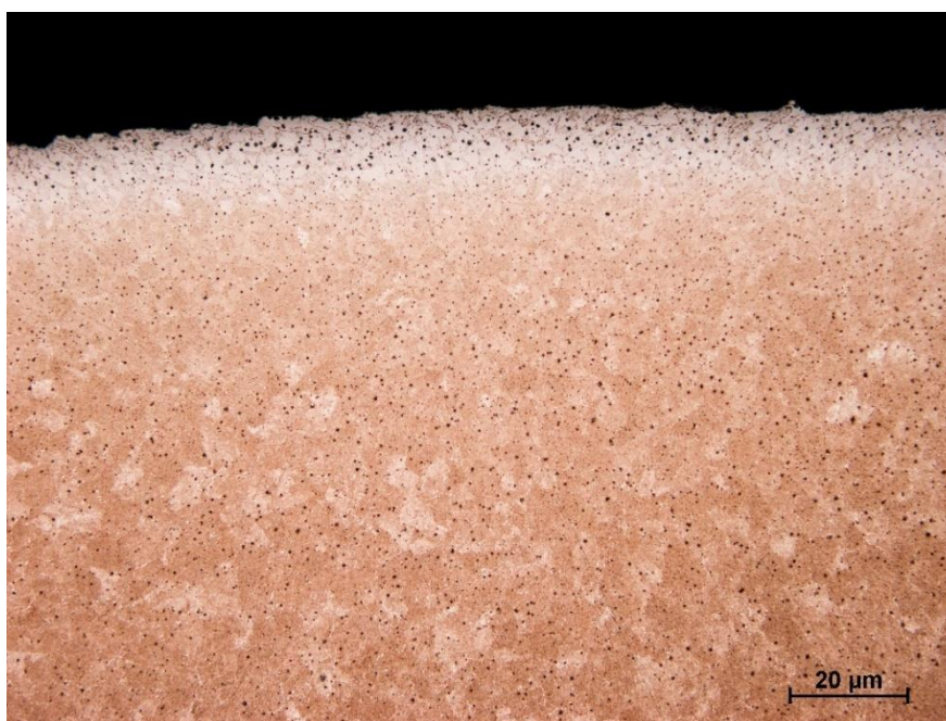
Obr. 50 Mírně oduhličený okraj vzorku č. 1 oceli 19 191, zvětšení 1000x
