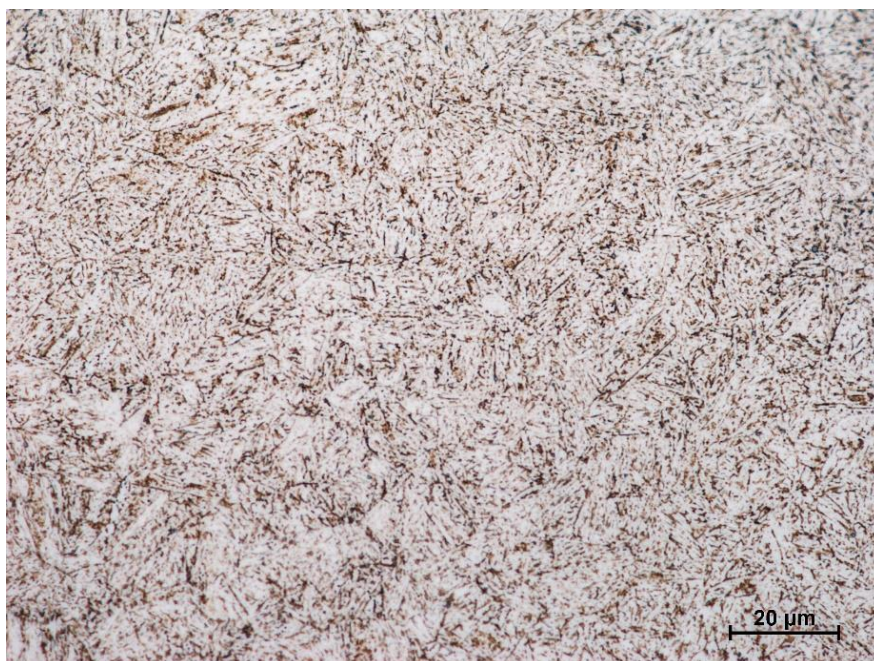
Obr. 45 Mikrostruktura vzorku č. 4 oceli 16 640, zvětšení 1000x
