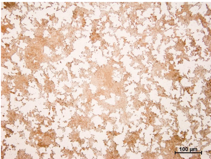
Obr. 51 Mikrostruktura vzorku č. 2 oceli 19 191, zvětšení 200x
