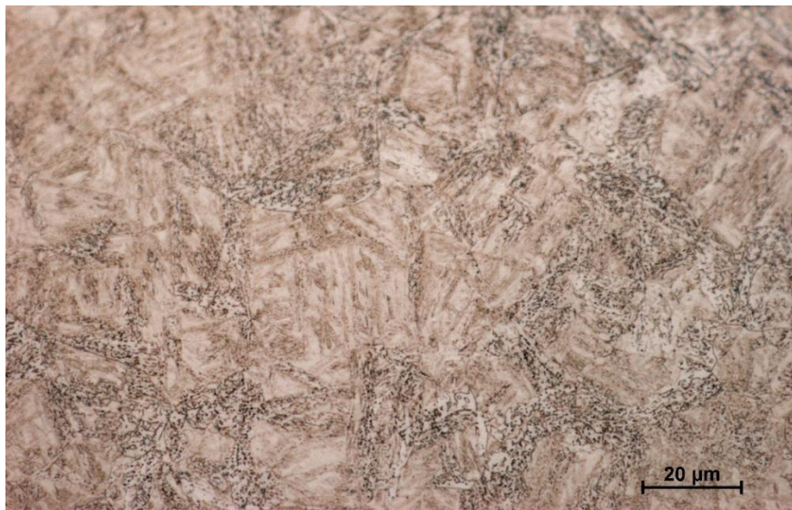
Obr. 42 Mikrostruktura vzorku č. 1 oceli 16 640, zvětšení 1000x
