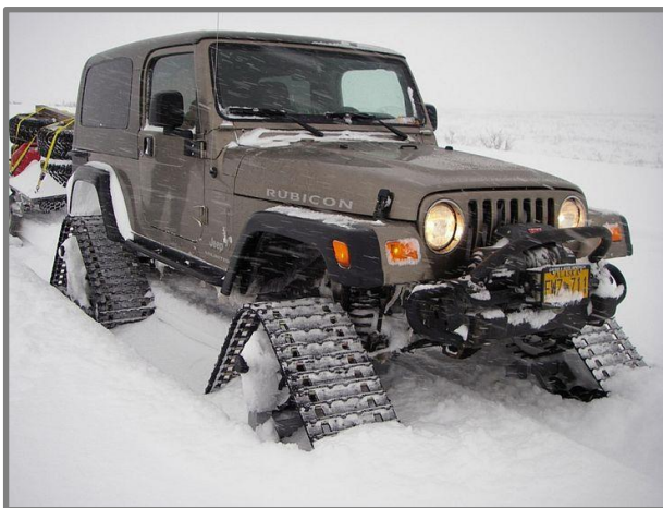
Obr. 18 Jeep Wrangler vybavený podvozkem Dominator [23]
