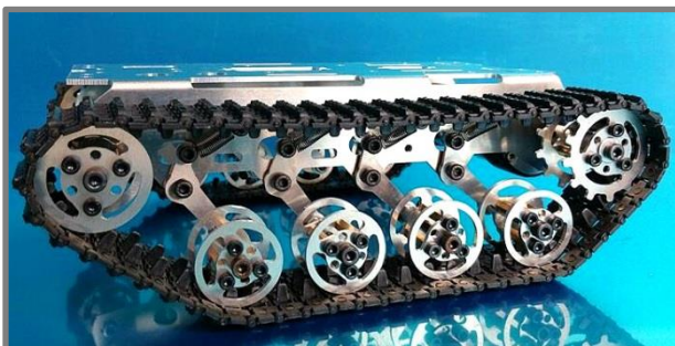
Obr. 32 Model nezávislého zavěšení pojezdových kol [31] Obr. 33 Lisové odpružení bagru Bobcat [32]
