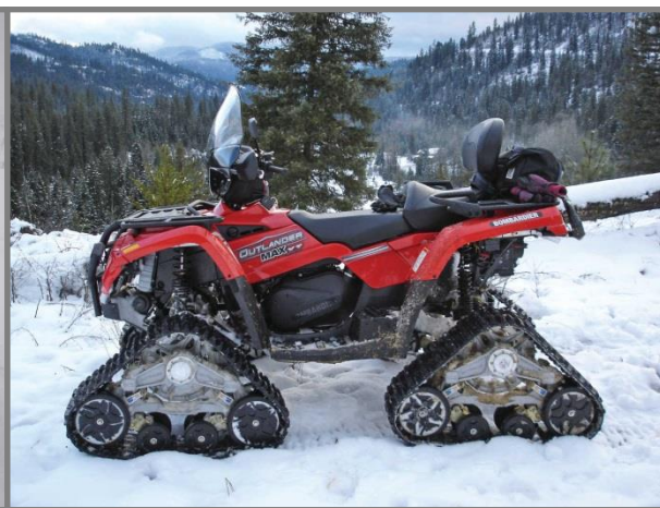
Obr. 19 ATV Bombardier vybavený systémem MatTracks LiteFoot [24]
