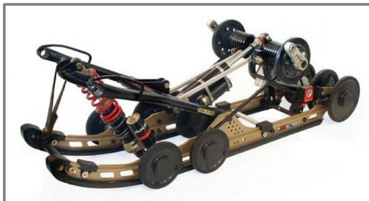
Obr. 38 Zavěšení pásu skútru s torzní pružinou [34]
