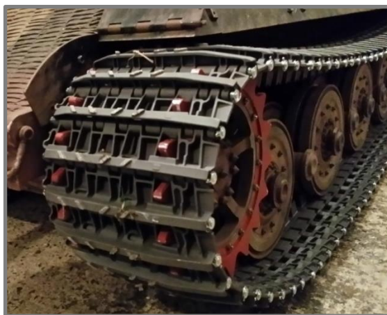
Obr. 25 Kovový pás tanku Tiger [36]
