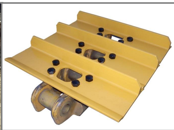
Obr. 26 Kovový pás s opěrnými deskami [37]
