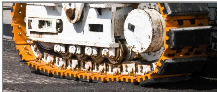
Obr. 30 Gumové pásové vložky na buldozeru [40]
