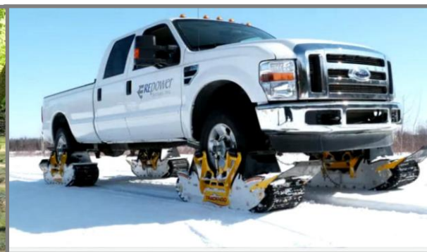
Obr. 21 Ford vybavený pásy Track'n Go [25]
