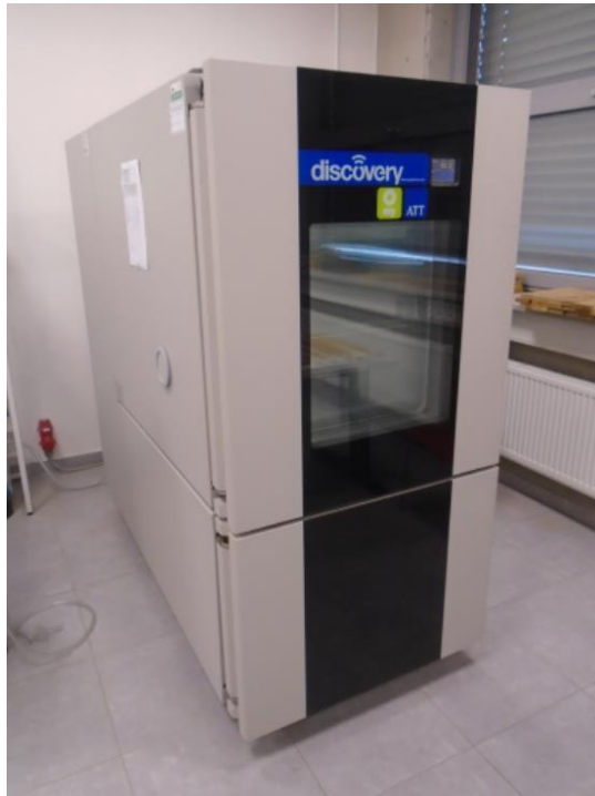
Obr. 18: Klimatizační komora typ Discovery My DM340 (Zdroj: autorka)
