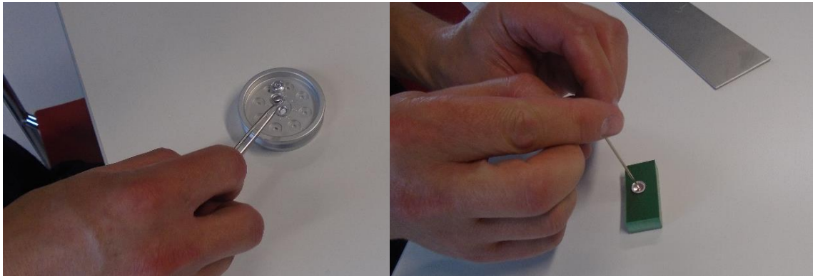
Obr. 21: Vlevo - příprava vzorku adheziva pro termickou analýzu, vpravo - příprava víčka kelímku pro termickou analýzu (Zdroj: autorka)
