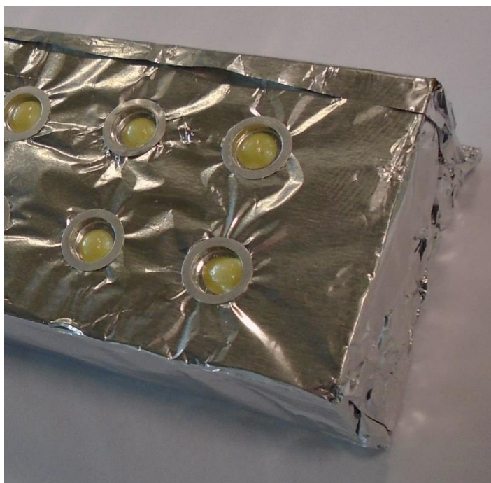
Obr. 20: Vzorky adheziv aplikované do hliníkových kelímků (Zdroj: autorka)
