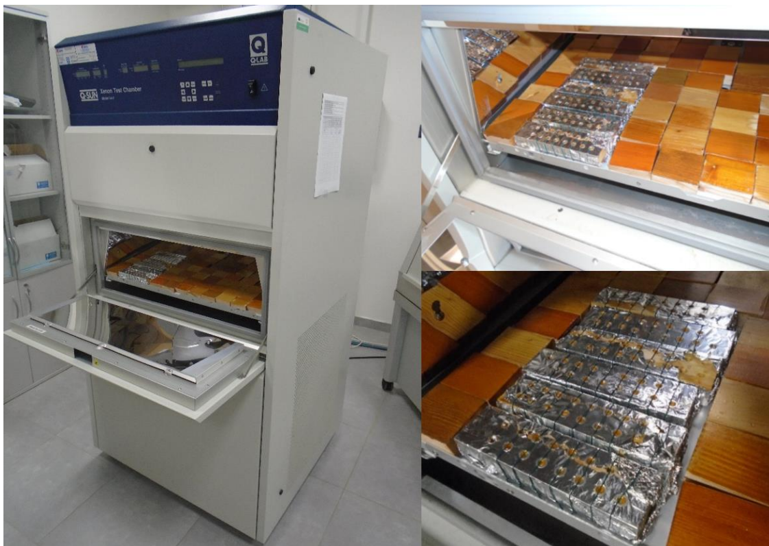
Obr. 16: Komoře Q-SUN (Xe-3) pro testy umělého stárnutí se vzorky adheziv (Zdroj: autorka)
