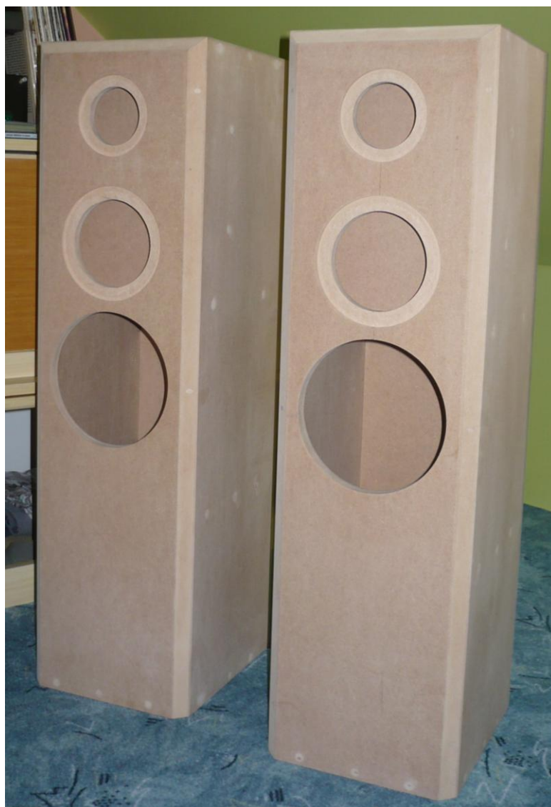
Obr. 1: Neosazené skelety reproduktorové soustavy
