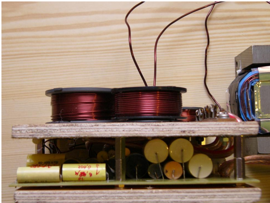
Obr. 3: Boční pohled zkompletované reproduktorové výhybky
