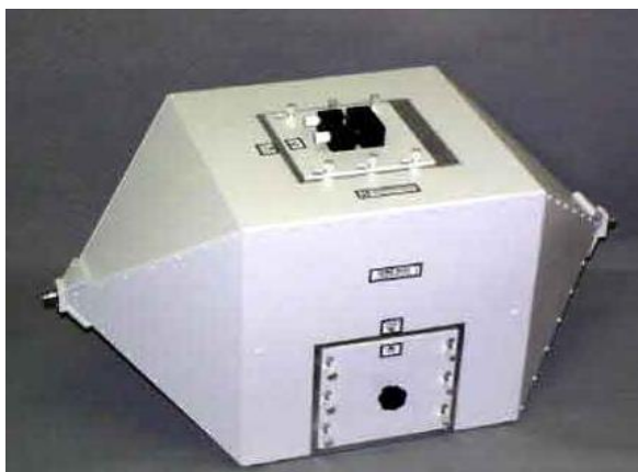
Obr. 2.7 Uzavřená TEM buňka [8]
