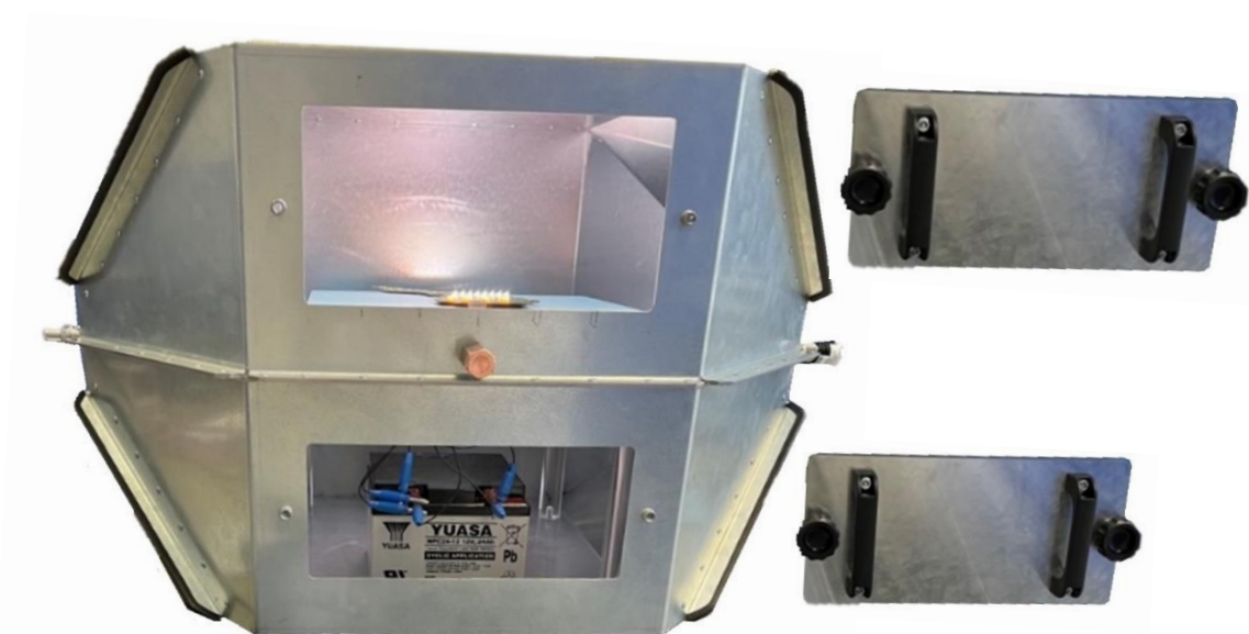
Obr. 4.20 Pracoviště uzpůsobené k měření emisí
