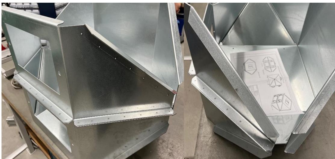
Obr. 4.4 Stavba TEM buňky z jednotlivých dílů
