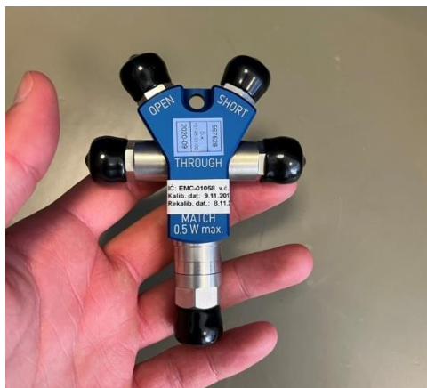
Obr. 4.7 Kalibrační kit TOSM a 50Ω přizpůsobovací člen (10W)
