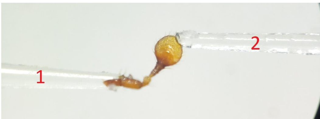
Obrázek 6: Izolované tykadlo Ips typographus zapojené mezi skleněné elektrody naplněné Ringerovým roztokem. 1 – referenční elektroda, 2 – měřicí elektroda. Zvětšeno 80x. Autor: Jaromír Bláha
