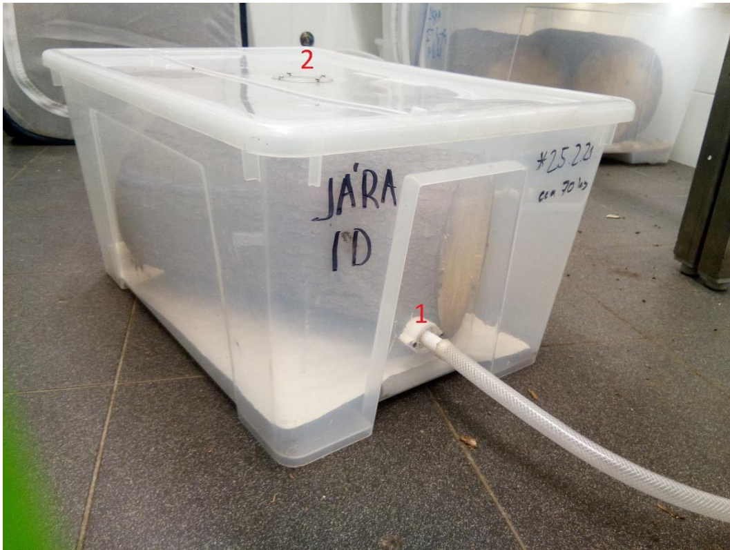
Příloha 1: Chovný plastový box s infestovaným polenem podloženým papírovou utěrkou. V zadní části je vidět otvor a hadice pro odtah vzduchu (1), ve víku otvor překrytý sítkou pro vstup čerstvého vzduchu (2). Autor: Jaromír Bláha
