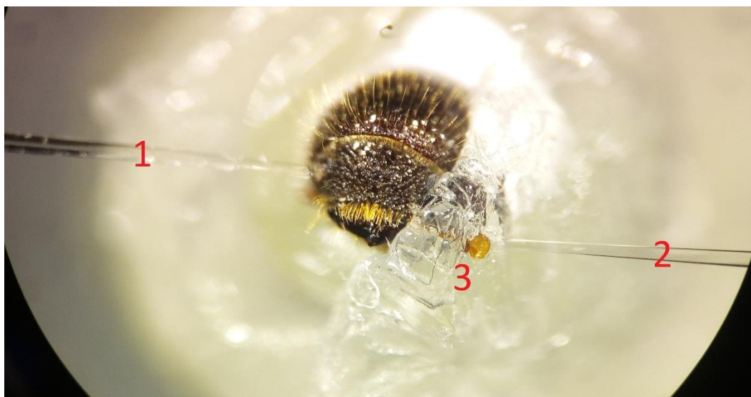
Obrázek 8: Zapojený celý živý brouk Ips typographus mezi skleněnými elektrodami naplněnými Ringerovým roztokem. Referenční elektroda (1) je zapíchnuta do oka a měřicí elektroda (2) je zapojena na tykadlo zafixované do vosku (3). Zvětšeno 60x. Autor: Jaromír Bláha
