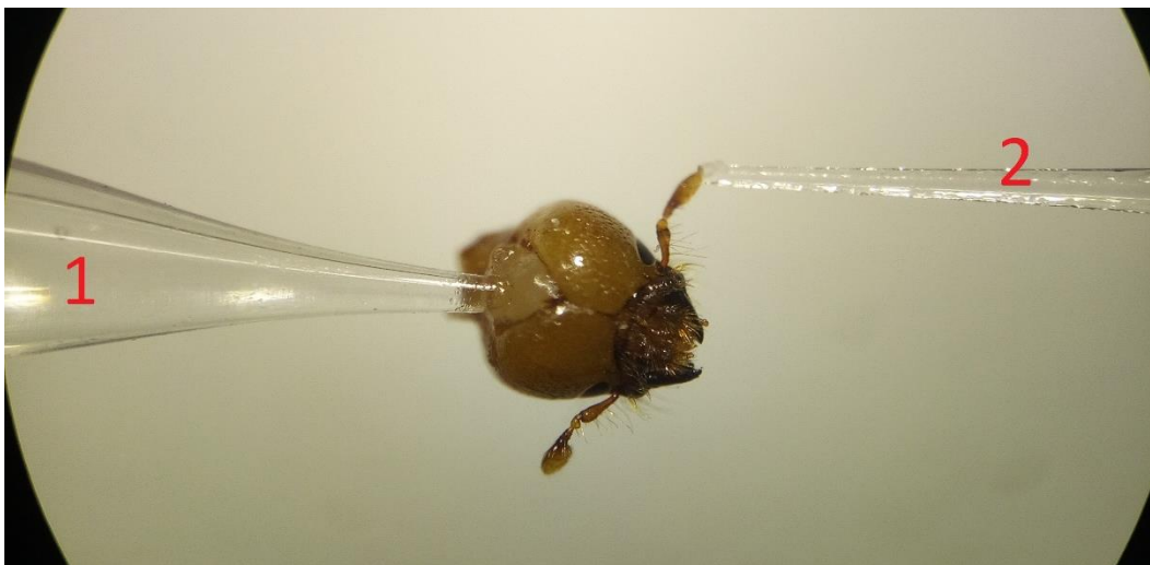
Obrázek 5: Tykadlo s hlavou Ips typographus zapojené mezi skleněné elektrody naplněné Ringerovým roztokem. 1 – referenční elektroda, 2 – měřicí elektroda. Zvětšeno 60x. Autor: Jaromír Bláha
