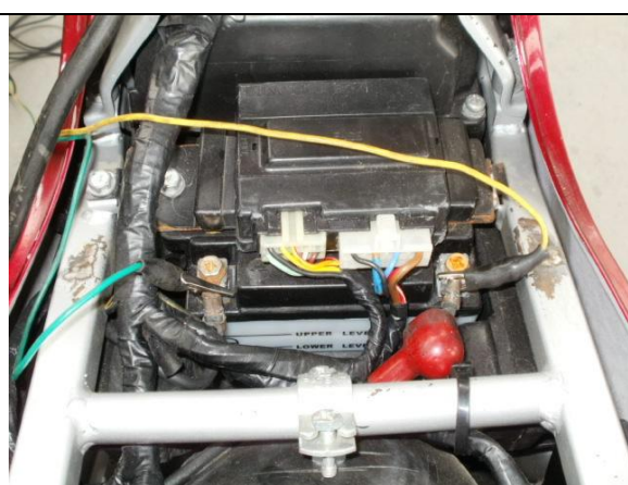
c) zapojení snímače impulzů na akumulátor motocyklu
