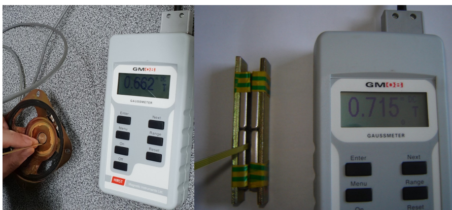
Obr. 4.28: Měření magnetické indukce, vlevo reproduktoru v mezeře pro cívku, B_p = 0,662 T, vpravo 4 ks NdFeB magnetů 40 x 20 x 5 mm, B_p = 0,715 T (vlastní zpracování).
