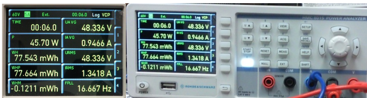
Obr. 7.5: Výkonový analyzátor HMC 8015 pro měření celkového elektrického příkonu. Zobrazuje a zaznamenává data rychlostí 10 záznamů za sekundu, především pak okamžitý elektrický příkon DC do ŘJ (zde 45,70 W) při odpovídajících otáčkách motoru (zde n_{mot} = 2000 1/min, odpovídá 16,667 zdvihů ventilu za 1 sekundu, čili frekvenci 16,667 Hz) a dále přijatou energii (77,664 mWh = 279,59 J), vrácenou energii (-0,1211 mWh = -0,44 J) a výslednou energii (77,543 mWh = 279,15 J) za určený čas (6,0 s), během kterého bylo vykonáno 100 zdvihů při průměrné energii 2,79 J na jeden zdvih ventilu (vlastní zpracování)
