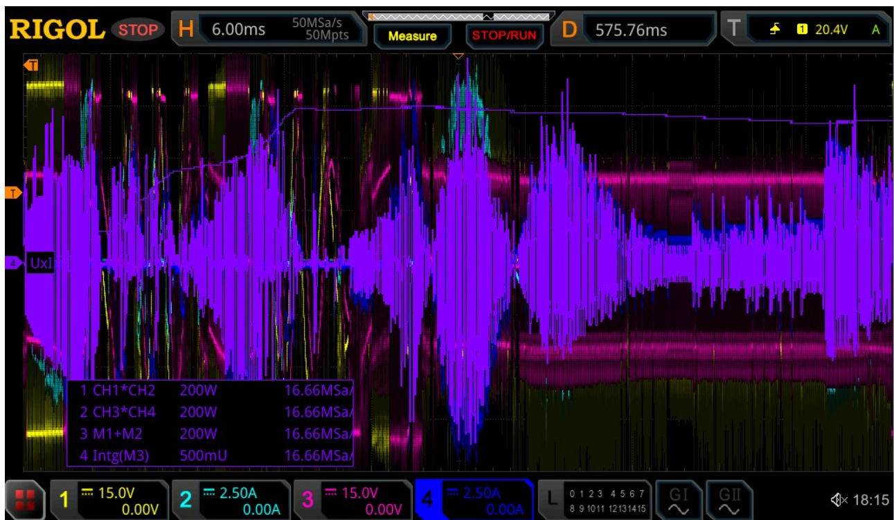
Obr. 7.4: Záznam z 2. osciloskopu měření elektrických AC veličin ŘJ během jednoho zdvihu ventilu při otáčkách motoru 2000 1/min, což odpovídá 16,667 zdvihů ventilu za sekundu a 1 perioda tedy trvá 60 ms. Měřená jsou výstupní AC napětí z ŘJ (žlutá a červená) a výstupní proudy (světle modrá a tmavě modrá) pro stanovení průběhu AC příkonu elektromotoru. V osciloskopu je možné zobrazit výpočet integrálu příkonu, který je roven průběhu energie. (vlastní zpracování).
