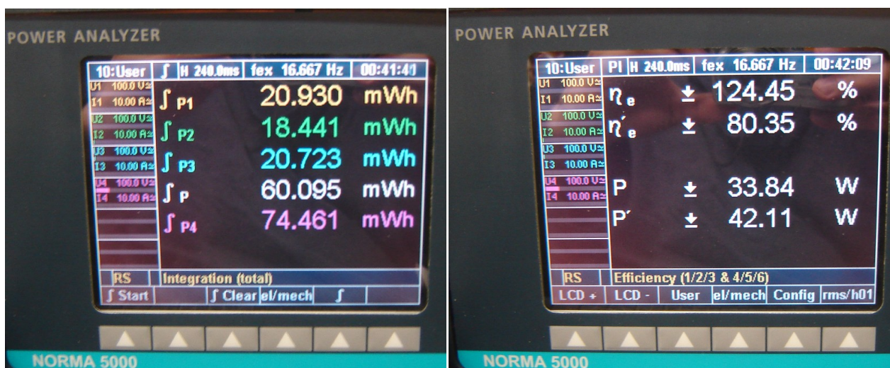
Obr. 7.6: Záznam z analyzátoru elektrické energie FLUKE NORMA 5000 pro měření elektrických AC a DC veličin ŘJ při otáčkách motoru 2000 1/min, což odpovídá 16,667 zdvihů ventilu za sekundu. Na obrázku vlevo je zobrazena AC energie jednotlivých fází BLDC elektromotoru (žlutá, zelená a modrá), součtová energie AC všech 3 fází (bílá, 60,095 mWh = 216,34 J) a energie DC silové části ŘJ (červená) za určený čas 6,0 s, během kterého bylo vykonáno 100 zdvihů ventilu. Průměrná AC energie je 2,16 J na jeden zdvih ventilu. Na obrázku vpravo jsou zobrazeny okamžité výkonové hodnoty AC (33,84 W) a silové DC (42,11 W) a z nich vypočtená účinnost silové části ŘJ pro motorický režim (AC/DC, 80,35 %), popř. pro generátorický režim (DC/AC, 124,45 %), což je v tomto případě neplatná hodnota. (vlastní zpracování)
