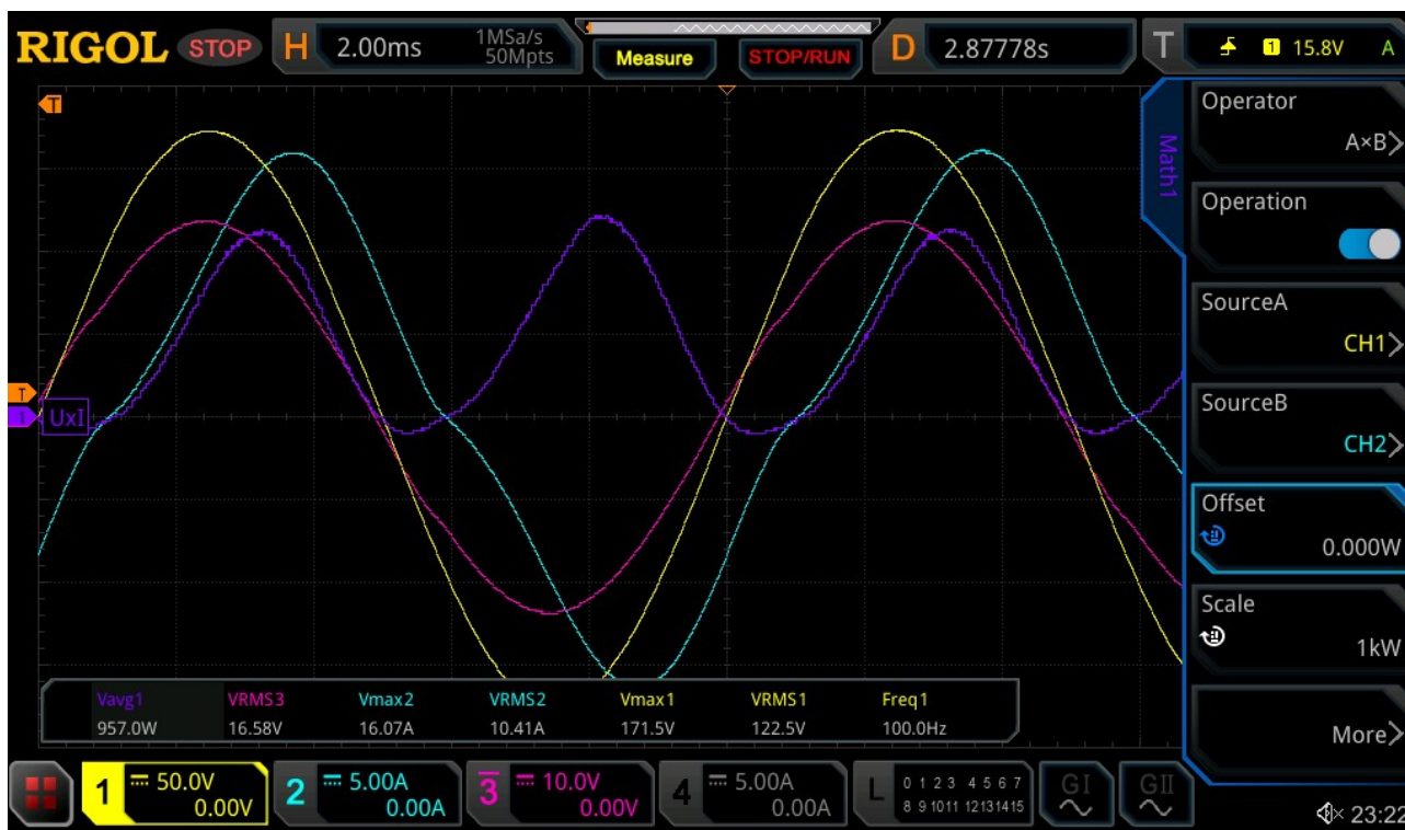
Obr. 4.21: Měření ztrátového výkonu elektromagnetu osciloskopem při 100 Hz, žlutá křivka - napětí cívky, U = 123 V, světle modrá - proud cívkou, I = 16,1 A, červená - napětí na sekundární měřící cívce 16,58 V, indukované napětí U_{mag} je 6,67 x větší, tedy 110 V a tmavě modrá - okamžitý ztrátový výkon elektromagnetu daný součinem napětí a proudu cívkou, celkový střední příkon elektromagnetu P_{celk} = 957 W (vlastní zpracování)
