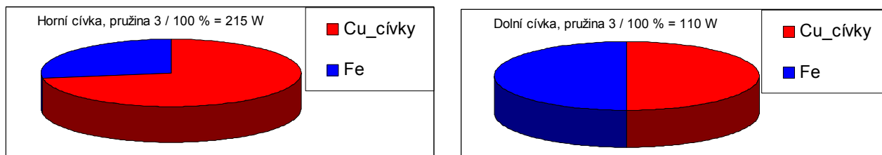
Obr. 4.18: Výkonové ztráty pro parametry pružiny 3, horní cívky (vlevo) a dolní cívky (vpravo) pro U_{MOVE} = 120 V, U_{HOLD} = 9,7 V (vlastní zpracování)
