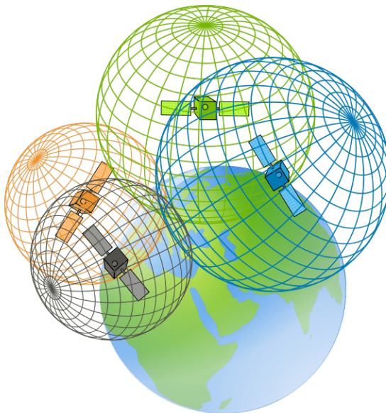
Obrázek 2.27: Určení pozice pomocí satelitů 33
