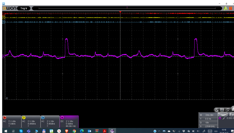
Obrázek 5.11: Průběh zapalovacích pulzů přizpůsobených vytvořeným obvodem
