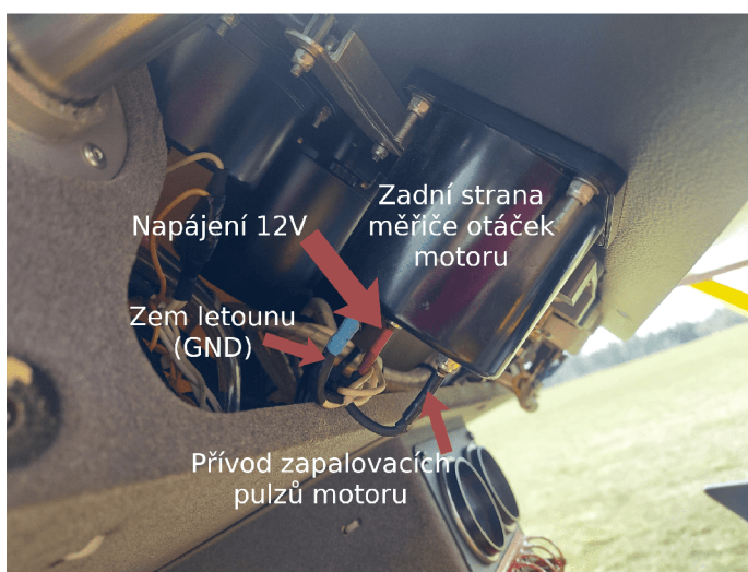
Obrázek 5.16: Pohled na zadní stranu přístrojové desky testovacího ultralightu
