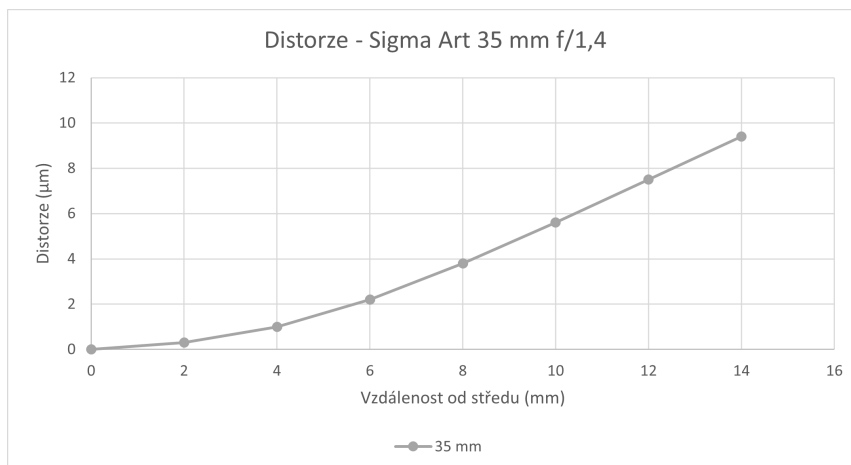
Obr. 4.3.4-2 Graf distorze objektiv Sigma Art 35 mm f/1,4.
