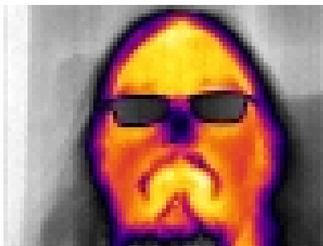
Obrázek 4.3: Snímek pořízený z termokamery Lepton 2.0, kde barevné rozmezí je mapováno na interval hodnot 7800 (černá) až 8100 (bíla/žlutá).
