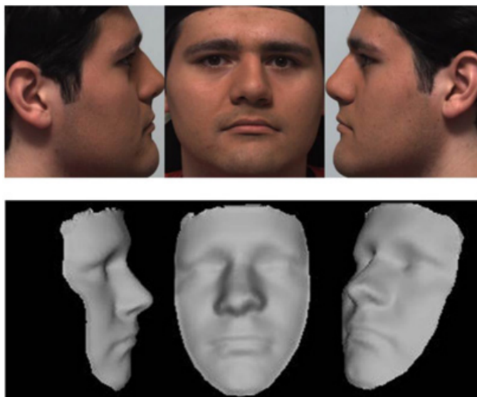
Obrázek 2.7: Příklad rekonstrukce 3D obličeje ze 3 snímků: čelní snímek a dvou profilových snímků [34].
