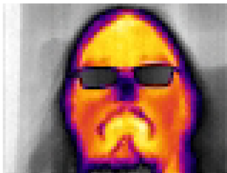
Obrázek 4.3: Snímek pořízený z termokamery Lepton 2.0, kde barevné rozmezí je mapováno na interval hodnot 7800 (černá) až 8100 (bílá/žlutá).
