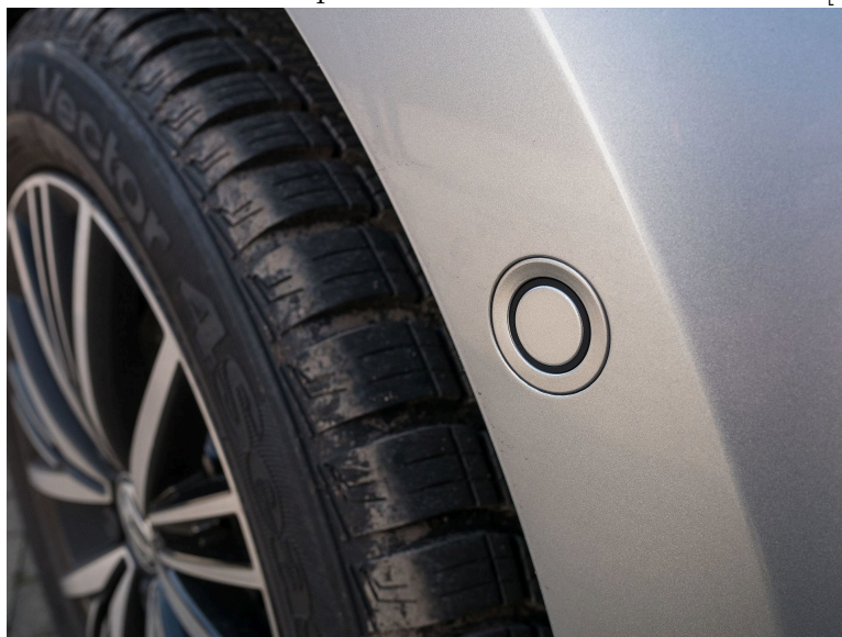
Obrázek 1.3: Ukázka parkovacího senzoru na VW Golf [33]
