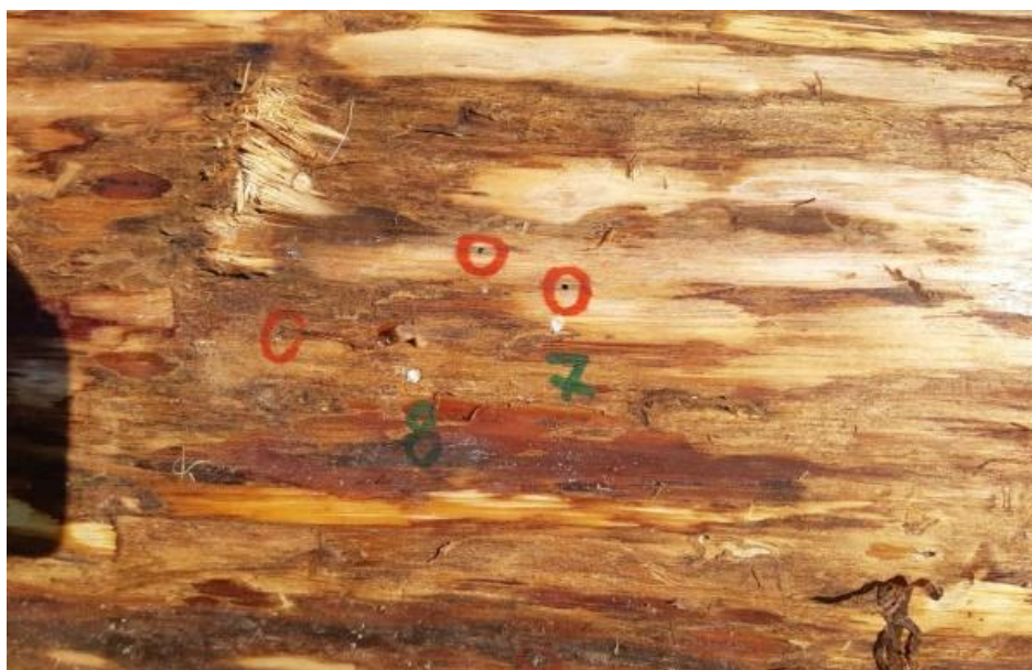
Obr. č. 10 - Závrtý dřevokaze čárkovaného a vstupy vrtáku do dřeva označeny číslicemi 7 a 8 (autor)
