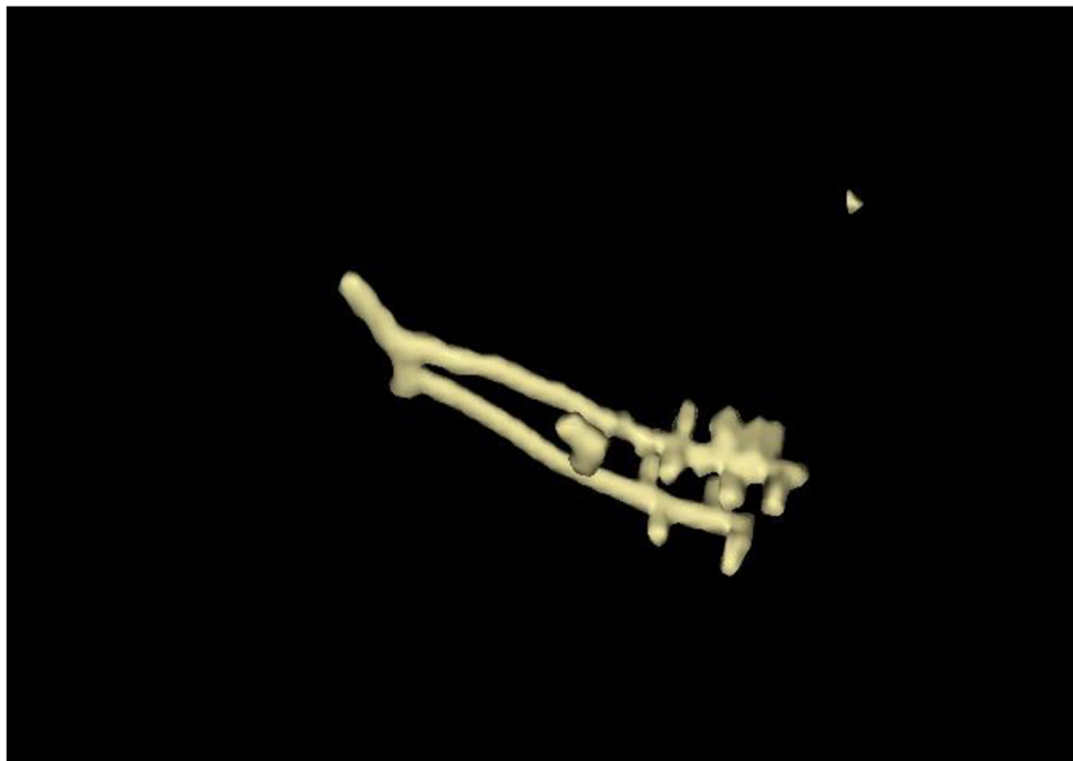
Obr. č. 17 - Chodba dřevokaze čárkovaného zvýrazněná kontrastní látkou ve 3D zobrazení (autor)
