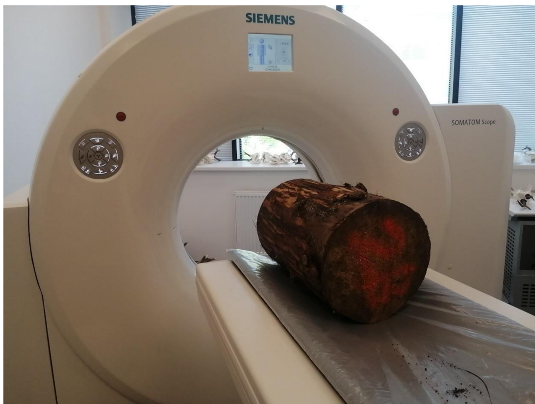
Obr. č. 5 - Skenování výřezů na multidetektorovém výpočetním tomografu (CT) (autor)
