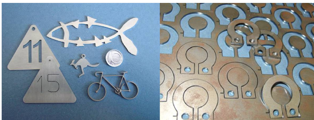
Obr. 4.4 Příklad možností laserového řezání malých součástí z plechu, použití mikromůstků 21
