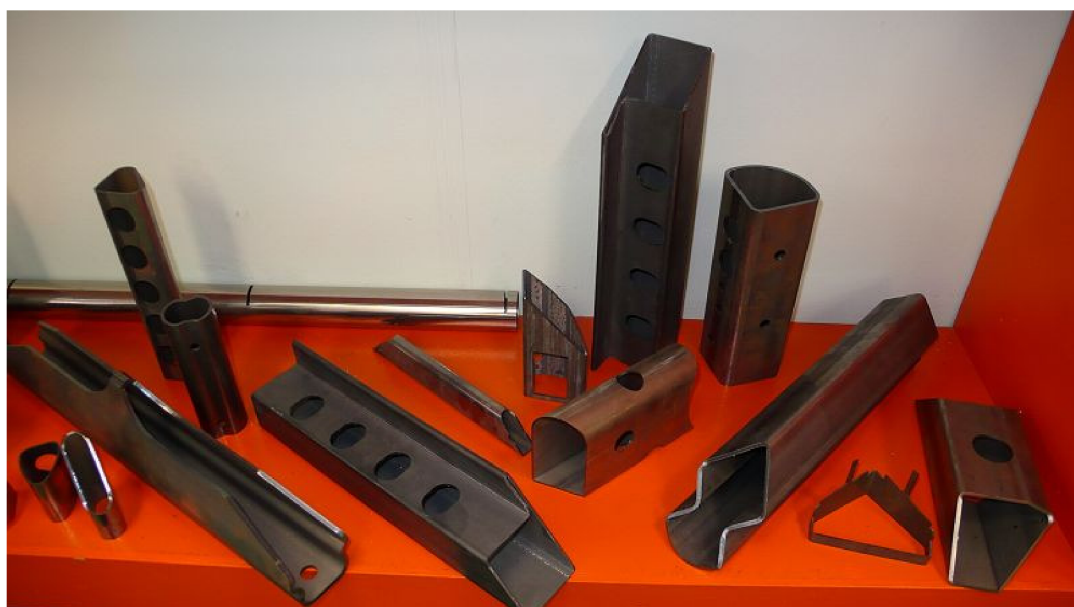
Obr. 4.5 Součásti vyřezané z tvarových profilů 25
