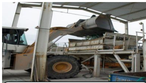
Předdrtič s magnetickou separací kovových částí
