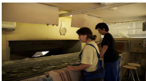
Odstranění hrubých nečistot pomocí ruční separace
