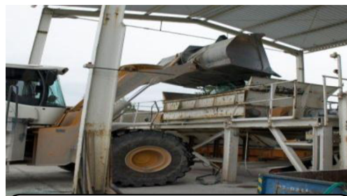
Předdrtič s magnetickou separací kovových částí
