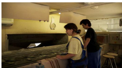
Odstranění hrubých nečistot pomocí ruční separace
