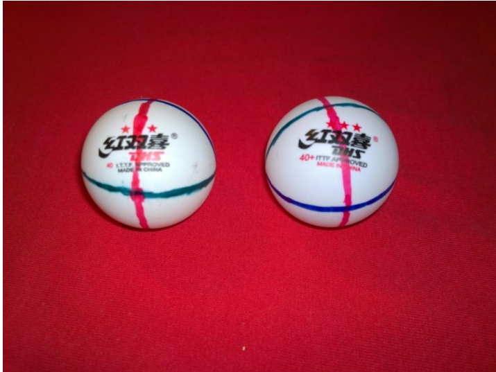
Obrázek 6.4: Míčky s namalovanými čarami, vlevo celuloidový a vpravo plastový míček
