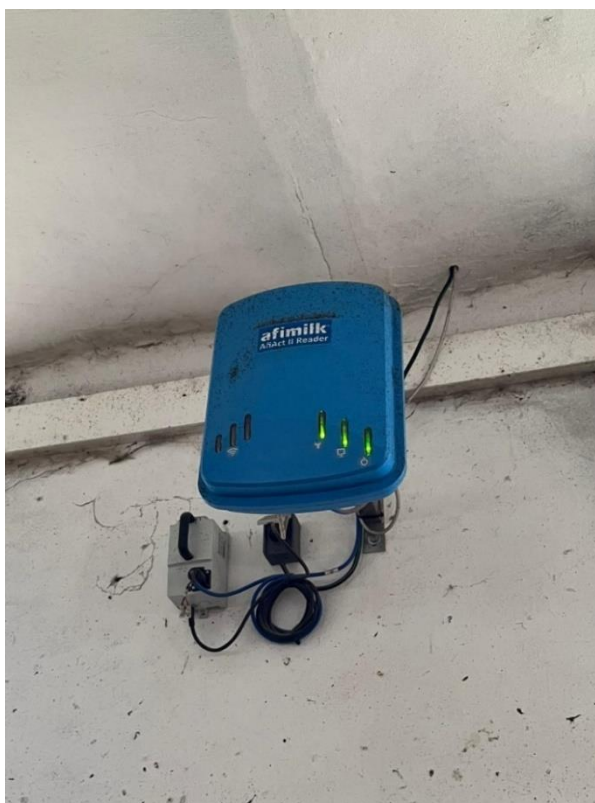
Obrázek 13: Anténa AfiAct II, která snímá pohybovou aktivitu krav (vlastní foto)
