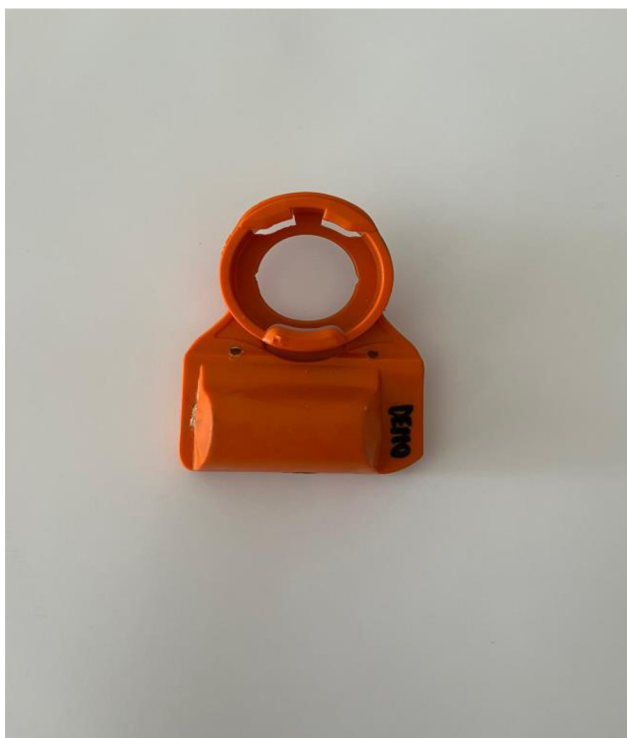
Obrázek 12: Ušní známka s elektronickou identifikací a pedometrem (vlastní foto)
