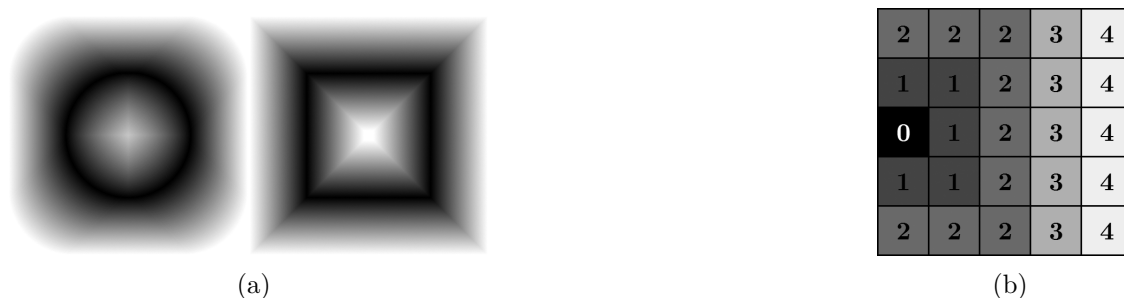
Obr. 1.9: Vzdialenostná transformácia v šachovnicovej metrike aplikovaná na vzorový obraz 1.2.
