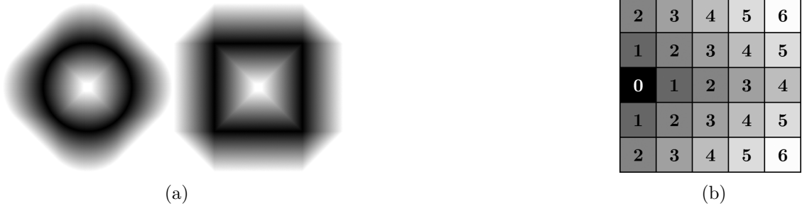
Obr. 1.7: Vzďialenostná transformácia v metrike mestských blokov aplikovaná na vzorový obraz 1.2.
