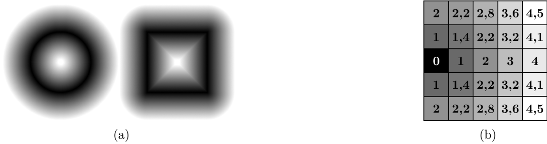
Obr. 1.3: Vzdialenostná transformácia v Euklidovskej metrike aplikovaná na vzorový obraz 1.2.
