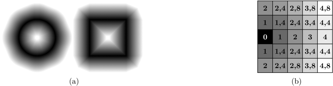
Obr. 1.11: Vzďialenostná transformácia v chamfer metrike aplikovaná na vzorový obraz 1.2.
