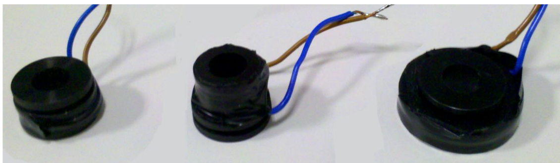
Obrázek 24: Skutečné provedení cívek (zleva: souměrná, vysoká, nízká)
