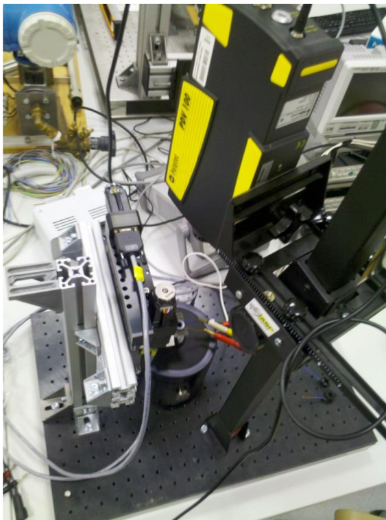
Obrázek 29: Měření indukovaného napětí
