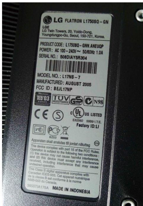
Obrázek 21: Fotografie výrobního štítku jednoho z prvních LCD monitorů, který nese označení „škrtnuté popelnice“ – vyroben v srpnu 2005 (Vlastní dílo, 2020).
