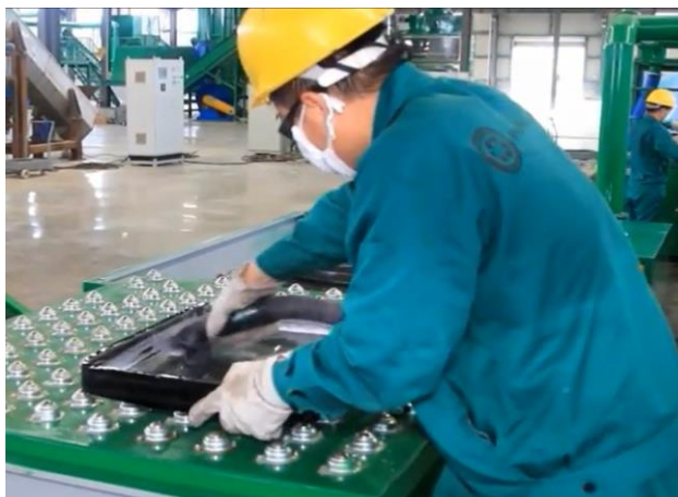
Obrázek 11: Fotografie recyklačního procesu CRT obrazovek – manuální (ruční) vysávání luminoforů (Recycling Tech Knowledge, ©2017).
