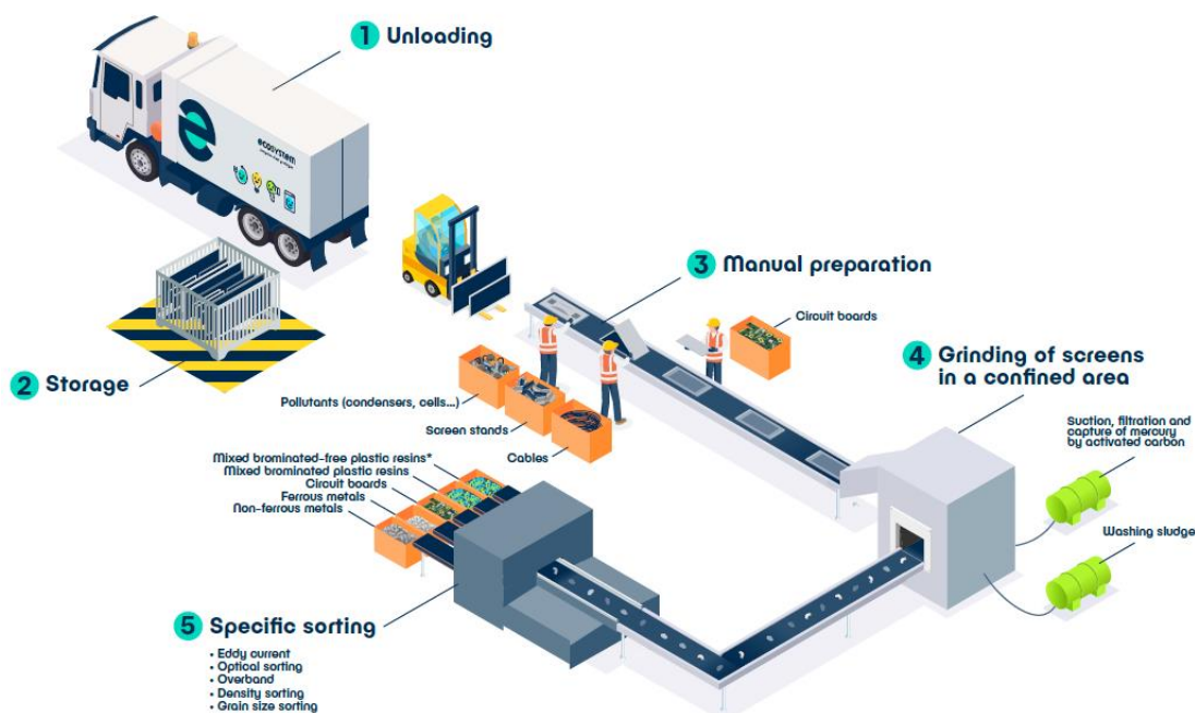
Obrázek 12: Schéma recyklačního procesu FPD obrazovek (automatizovaný) (Ecosystem, ©2020).
