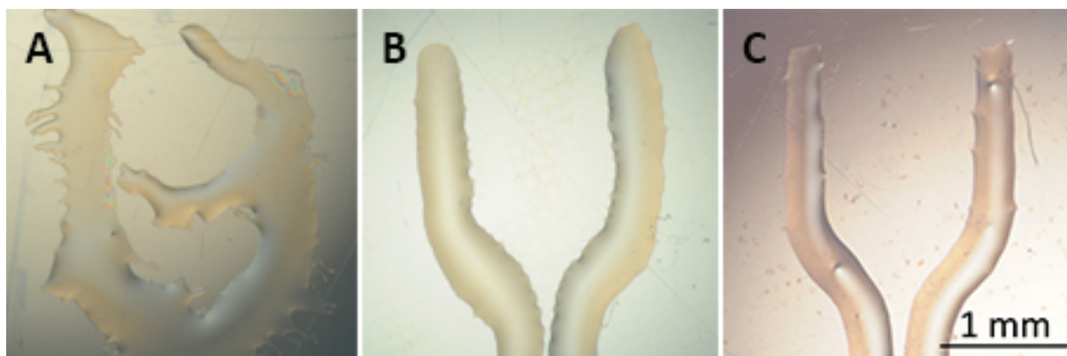
Obrázek 33. Test tisku různě zpolymerizovaného silikonu. (A) Silikon polymerizován hodinu při pokojové teplotě (standard). (B) Silikon polymerizován 30 minut při teplotě 80 °C. (C) Silikon polymerizován 32 min při teplotě 80 °C.
