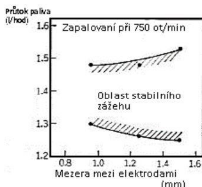
Graf 10 Oblast stabilního zápalu svíčky v závislosti na vzdálenosti elektrod [2]
