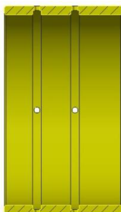
Obr. 23 Systém kanálků v kluzném ložisku rotoru
