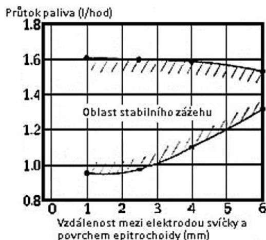
Graf 11 Oblast stabilního zážehu směsi v závislosti na vzdálenosti povrchu epitrochoidy a elektrody [2]
