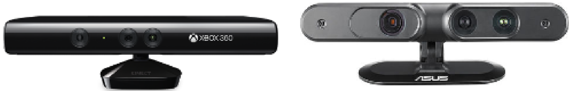
Obrázek 3.20: Ukázka zařízení pro snímání 3D prostoru. Vyobrazená zařízení kombinují prostorové informace s obrazovými – vlevo MS Kinect, převzato z [41], vpravo Xtion Pro Live, převzato z [39].
