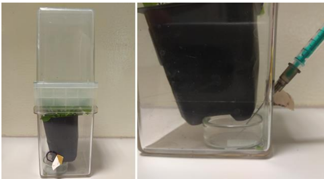
Obr. 6 (A) Nádoba pro aplikaci éteru. Černým kruhem je označen otvor pro vstříknutí éteru a vedle lepicí páska pro uzavření otvoru. (B) Aplikace éteru do plastové nádoby pomocí injekční jehly.
