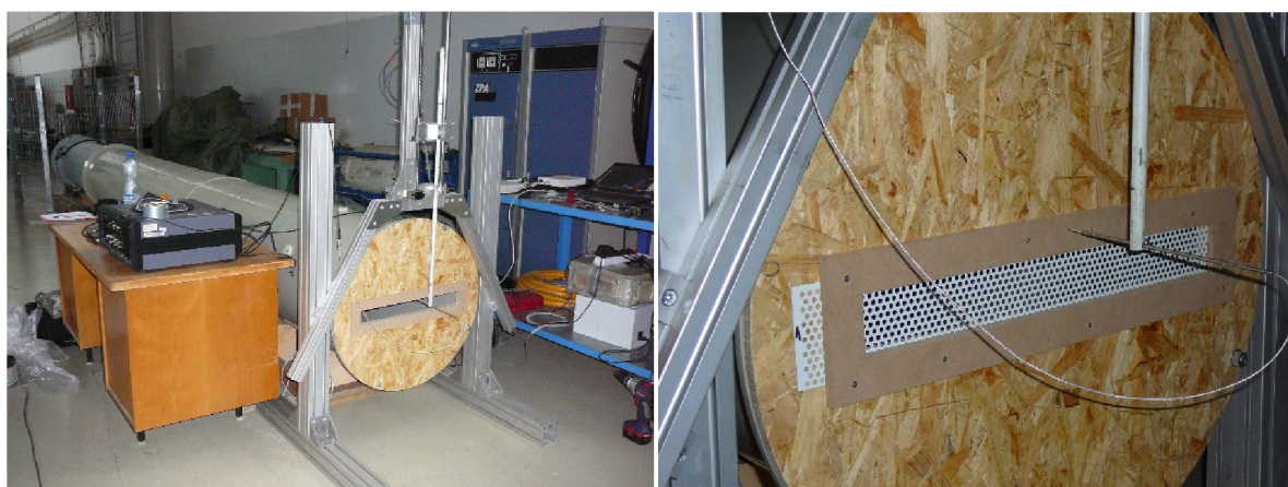
Obr. 25 Ventilátorová dráha ve VZLÚ v Praze, detail osazení mřížky v záklopu [53],[73]
