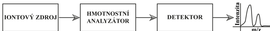
Obrázek 8: Schéma hmotnostního spektrometru
