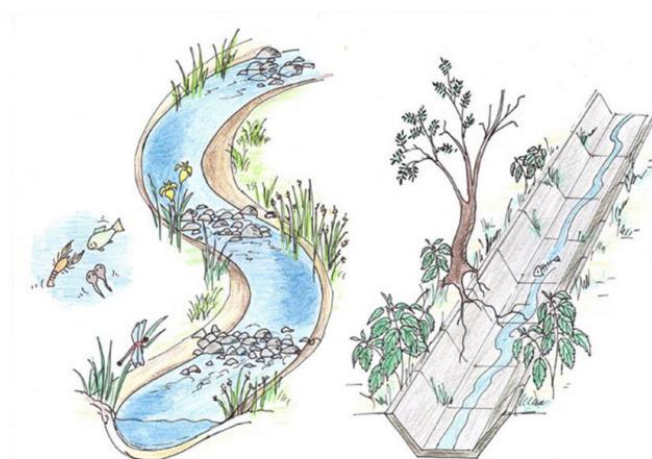
Obrázek 7: Revitalizované a technické koryto (enviregion.pf.ujep.cz, 2022)
