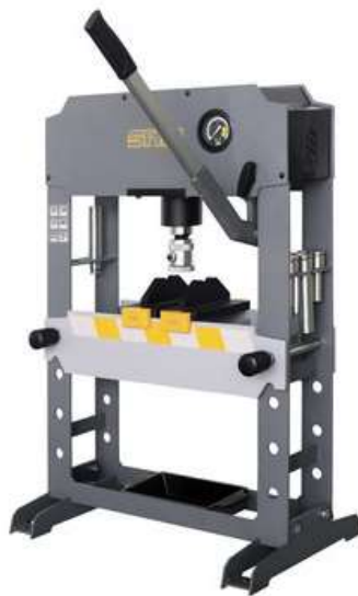
Obr. 3) Dílenský lis s ručním pohonem a svařovaným rámem [5]
