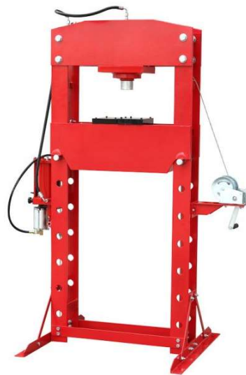
Obr. 4) Dílenský lis s přímým pohonem a děleným rámem [6]
