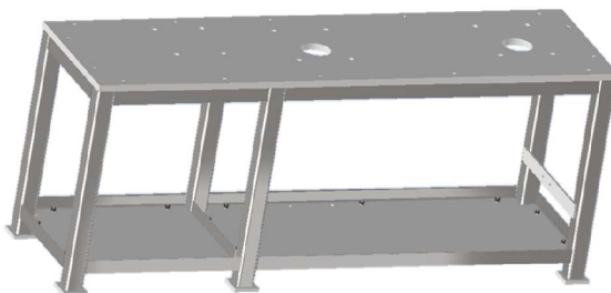
Obr. 23) Rám podstavce s vrchní deskou a spodními plechy
