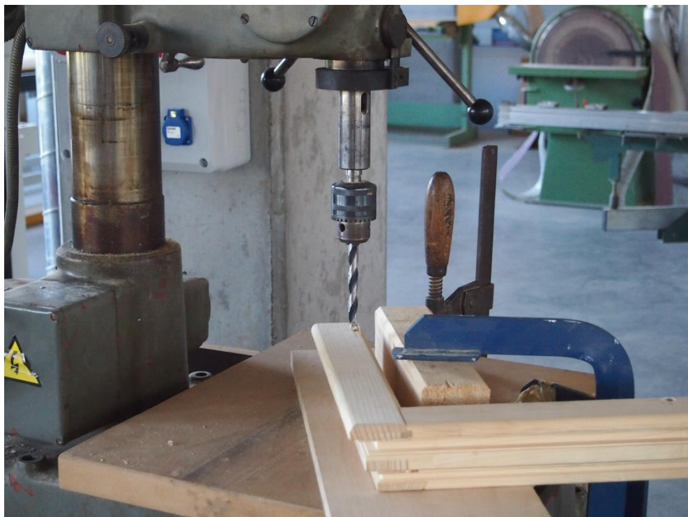
Příloha 6: Příprava zkušebních těles rohových spojů - klimatizace předvrtaných vzorků před testováním (foto autor)
