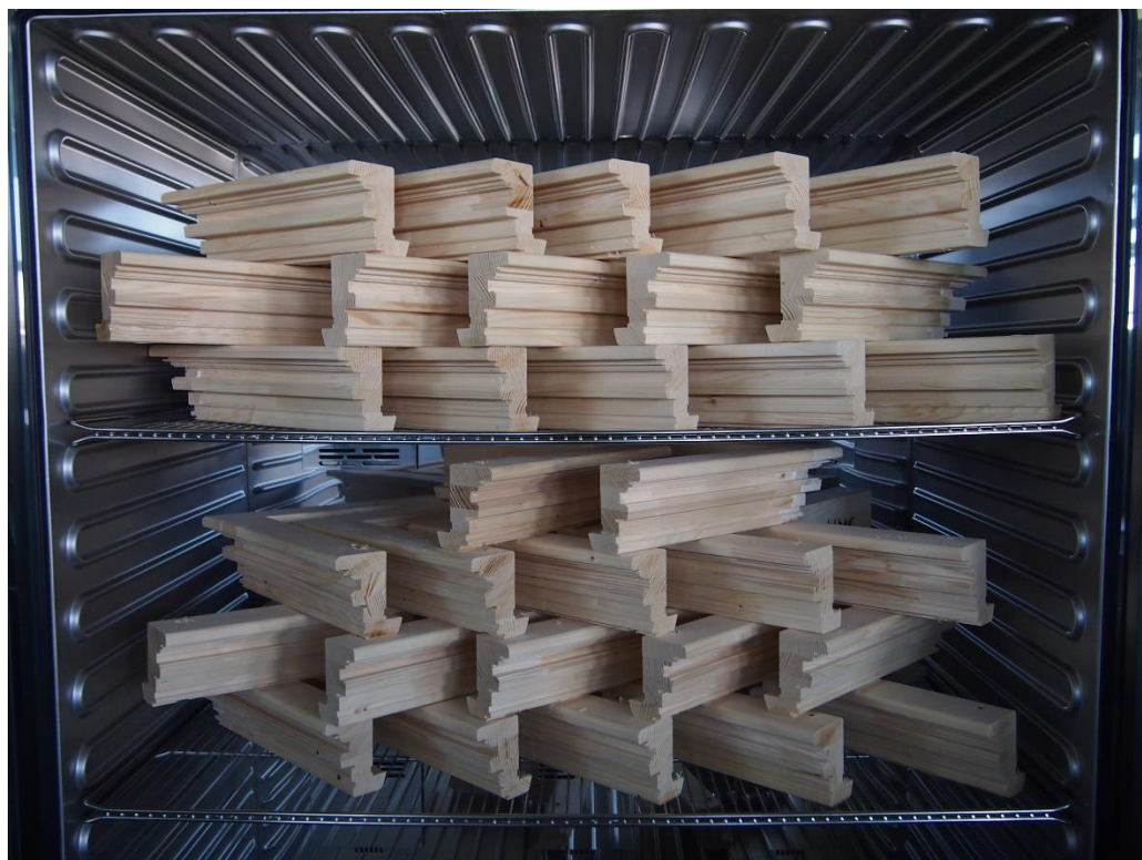
Příloha 6: Příprava zkušebních těles rohových spojů - klimatizace předvrtaných vzorků před testováním (foto autor)
