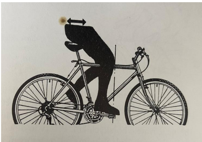
Obrázek 4: Předozadní nastavení sedla
