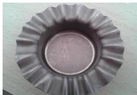
Obr. 13 Zvlnění příruby v důsledku anizotropie plechu [15]
