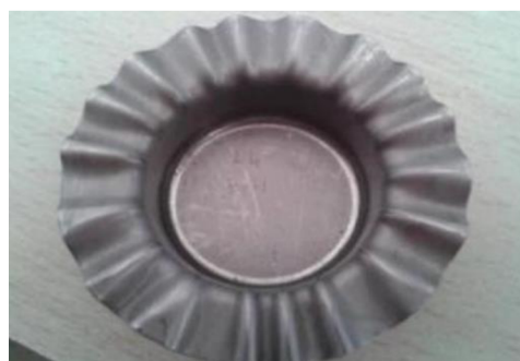
Obr. 13 Zvlnění příruby v důsledku anizotropie plechu [15]
