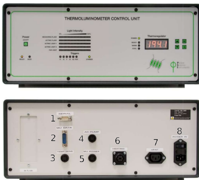
Obr. 1.9: Přední panel (nahore) a zadní panel (dole) řídicí jednotky. Konektory RS232 (1), MU - datové signály (2), MU - termistory (3), WCU (4), MU - napájení (5), MU - Peltierův článek a AHU (6), LNCU (7), síťové napájení (8). [9]
