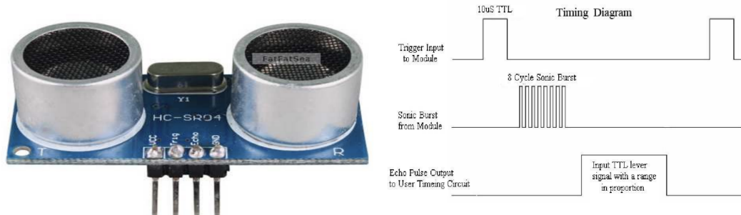
Obr. 5.7: Modul ultrazvukového senzoru HC-SR04 (vlevo) a jeho časový průběh vysílání a přijímání impulzů (vpravo), převzato z: [29]
