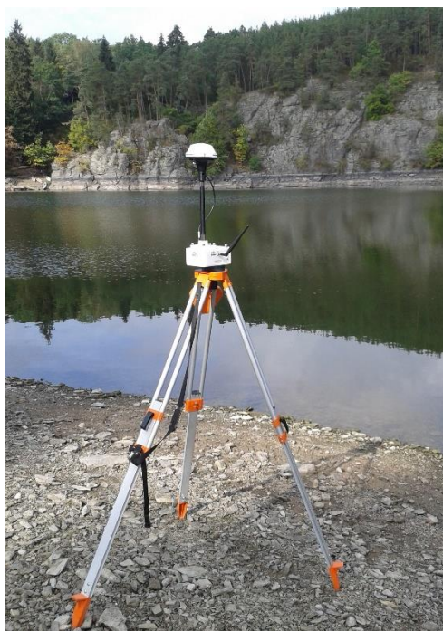
Obr. 8 – RTK stanice na stojanu (Autor, 2016)
